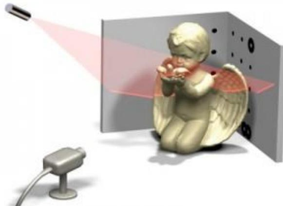
Immagine 2: Il funzionamento dello scanner a luce strutturata.
